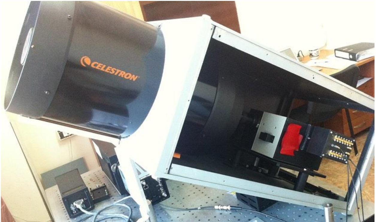
Рисунок 6. Фотография приемной системы лидара белого света.
