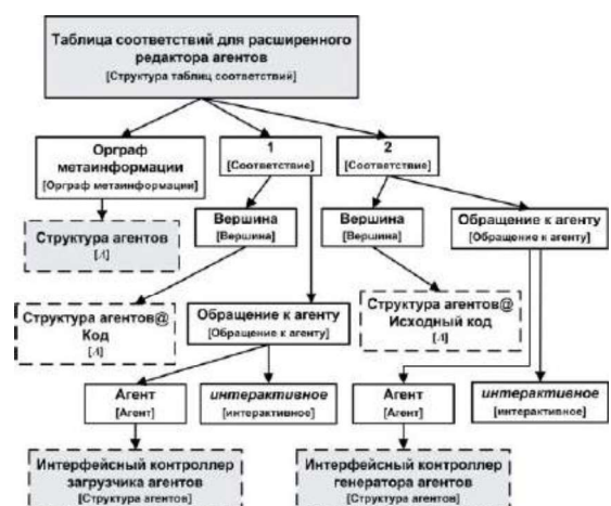
Рисунок 2 – Орграф информации, описывающий таблицу соответствий расширенного редактора агентов
