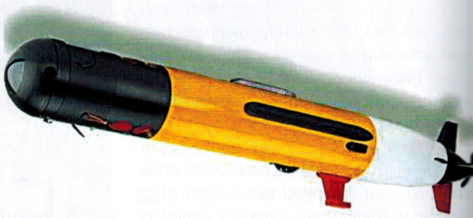
Рис. 15. НПА, предназначенный для движения по протяженным траекториям
